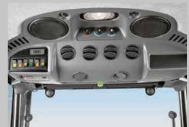
Panel klimatizace a topení se nachází na dobře dostupném místě ve stropu kabiny.
