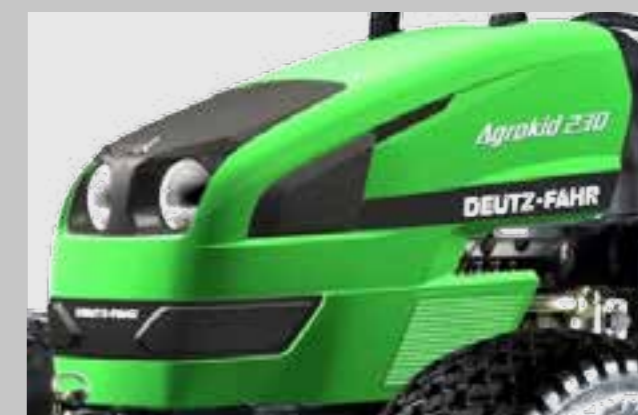
Speciální materiál používaný pro mřížky na kapotě se nazývá Telenu®.
