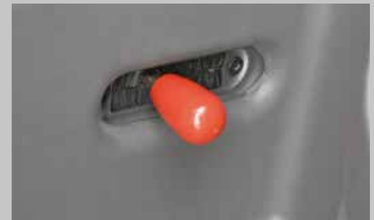
Převodovka s plazivými rychlostmi: 4 dodatečné převody pro práci při velmi pomalých rychlostech.
