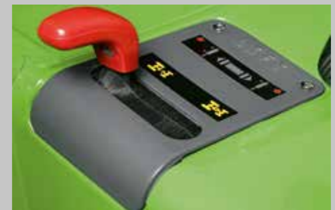
Pohon všech kol může být aktivován manuálně pro výrazné zvýšení trakce a snížení utužení půdy.
