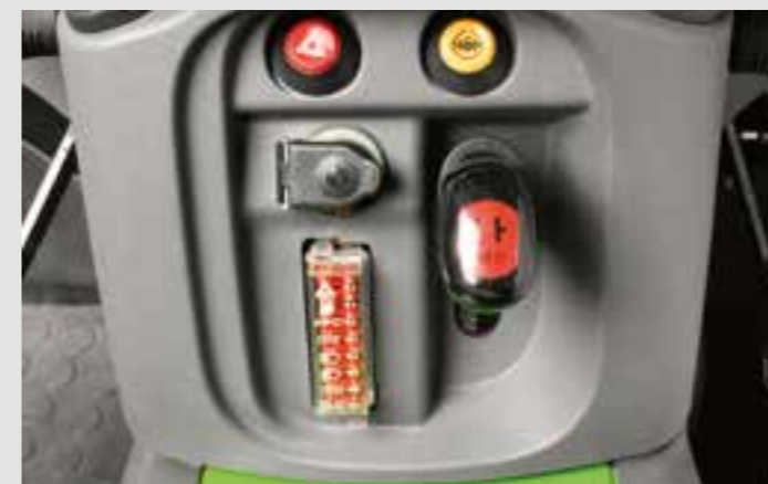
Pojistky jsou umístěné na sloupku řízení a pro jejich výměnu není nutná žádná složitá demontáž krytů a panelů.
