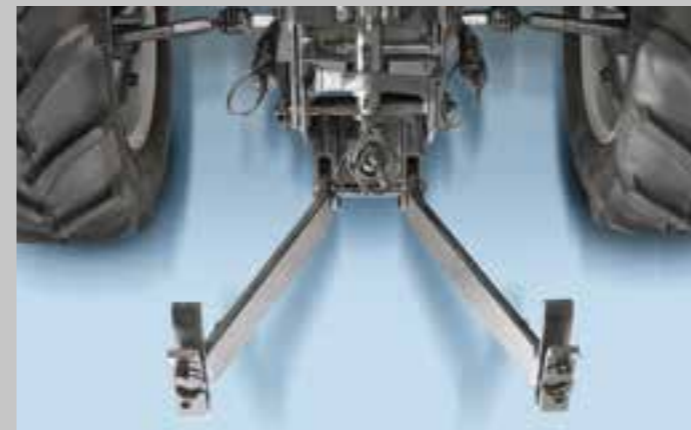
Přední tříbodobý závěs a přední PTO. Integrovaný přední tříbodobý závěs s maximální kapacitou až 600 kg, přední PTO je zpřevodována na 1 000 ot/min.
