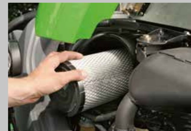
Vzduchový filtr se jednoduše vytáhne do boku po odepnutí horního krytu.
