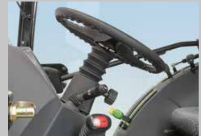
Výškově nastavitelný volant umožňuje každému řidiči nalezení ideální polohy.
