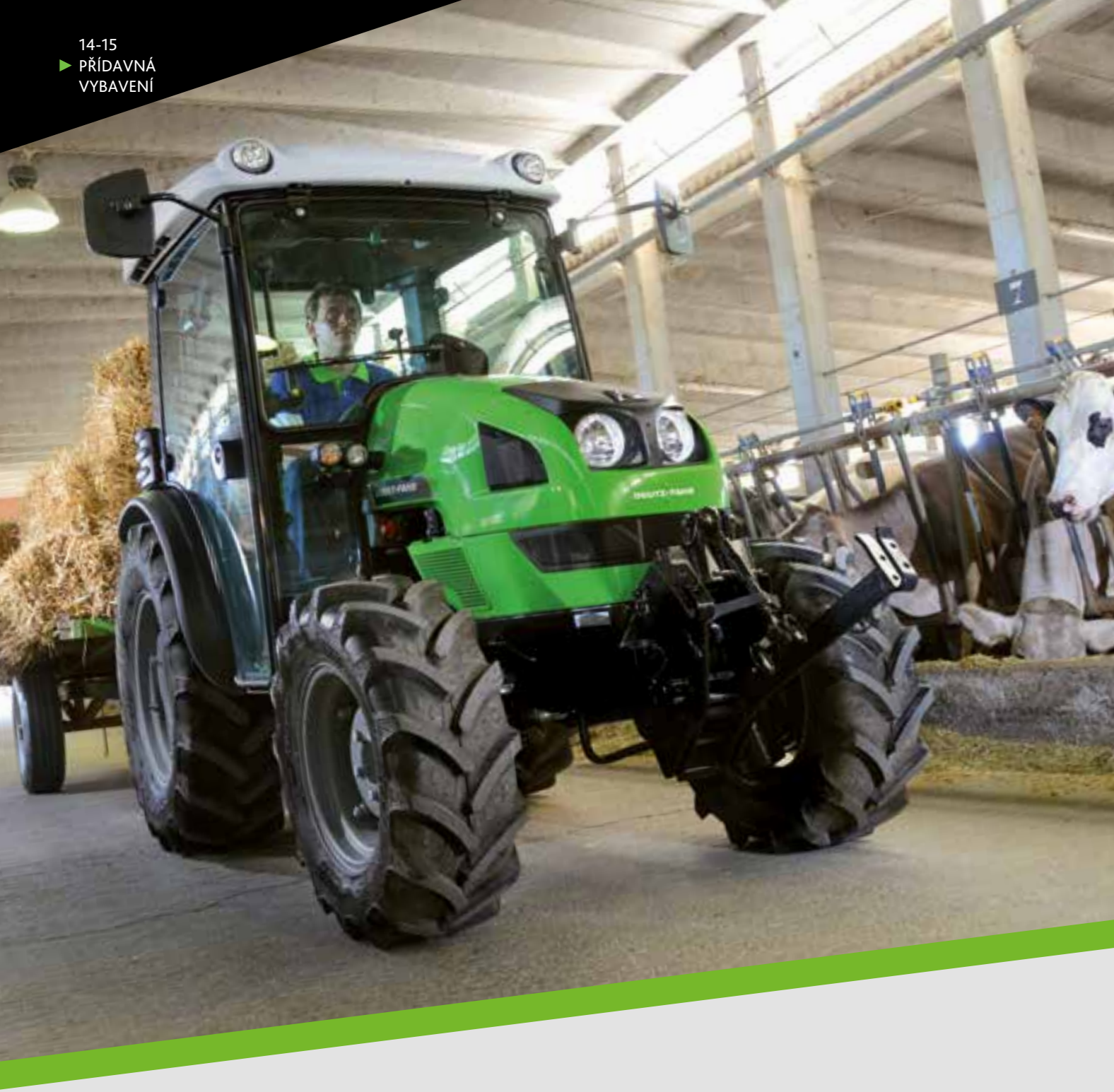
Přední tříbodobý závěs a přední PTO. Integrovaný přední tříbodobý závěs s maximální kapacitou až 600 kg, přední PTO je zpřevodována na 1 000 ot/min.
