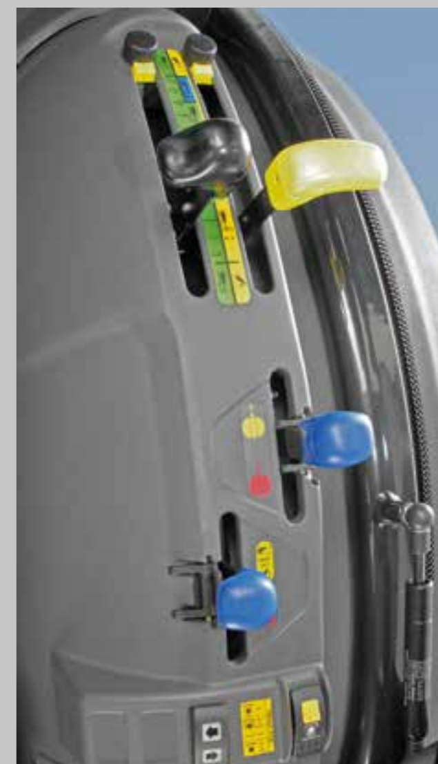
Mechanická regulace zadního třibodového závěsu je jednoduchá a efektivní. Třetí hydraulický okruh se aktivuje kolébkovým přepínačem.
