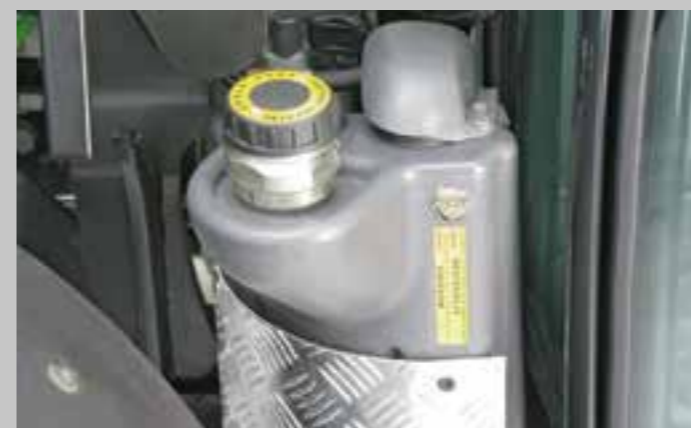
Přídavná palivová nádrž (15 l): pro zvládnutí i těch nejdělnějších dnů bez nutnosti dotankování.
