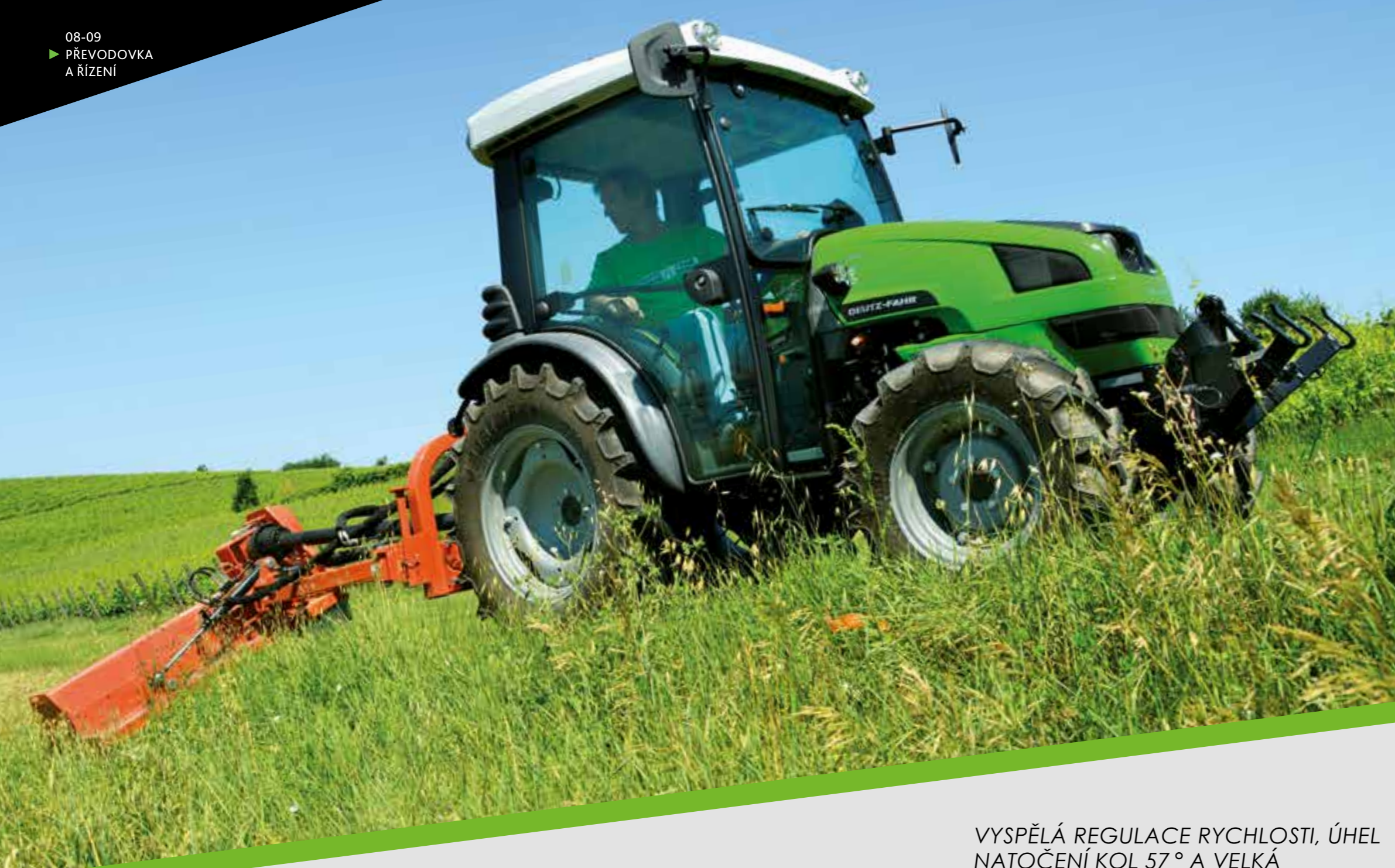
S úhlem natočení kol 57° má Agrokid velmi malý poloměr otáčení. Portálové nápravy zajišťují výjimečně vysokou světlou výšku až 390 mm.
