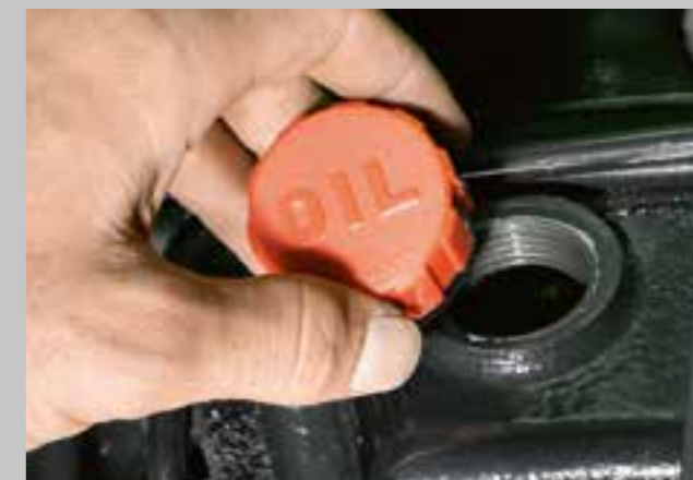
Plnicí hrdlo pro olej a měrka jsou velmi snadno přístupné.
