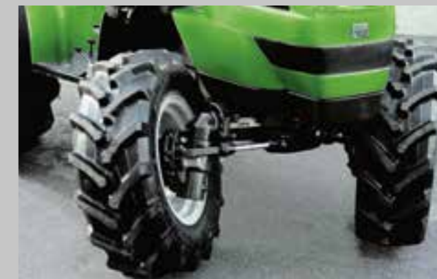
S úhlem natočení kol 57° má Agrokid velmi malý poloměr otáčení. Portálové nápravy zajišťují výjimečně vysokou světlou výšku až 390 mm.
